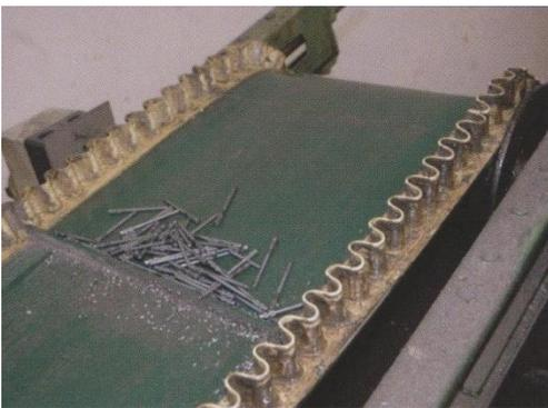
Die Volta Transportbänder weisen eine hohe Widerstandsfestigkeit gegen Einschnitte und Durchstiche auf.
