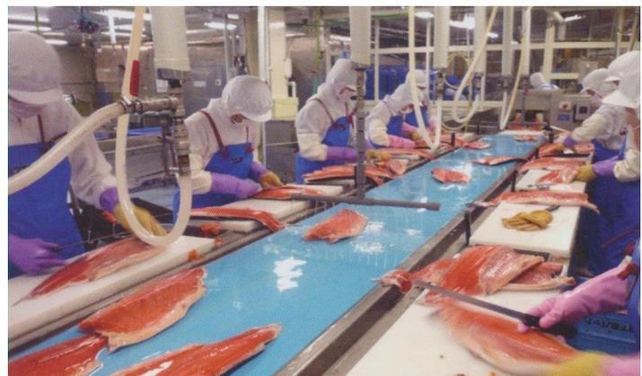
Unsere Förderbänder bestehen aus thermoplastischen Kunststoffen, die Wasser-, Öl-, Chemikalien-, Abrieb- und Schnittfest sind. Durch die homogene Beschaffenheit des Materials, das aus einem dicken, gewebefreien TPE besteht ist eine Lagentrennung ausgeschlossen. Unsere verstärkten Bänder haben zusätzlich eine Gewebelage auf der Laufseite.
